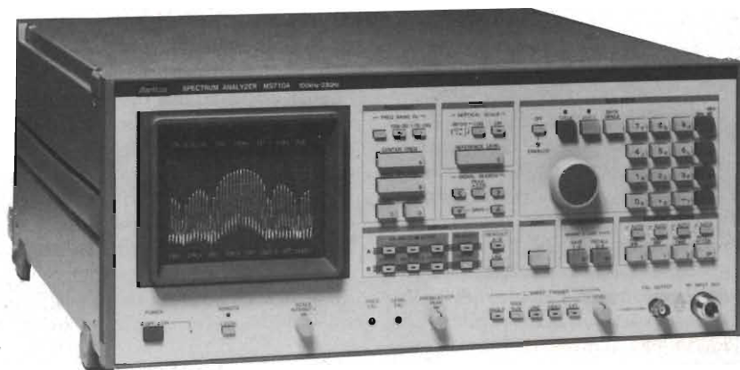
Fig. 3 - Analizzatore di spettro ANRITSU, modello MS 710A. È uno strumento che può essere utilizzato in VHF/UHF e microonde. La banda coperta va da 100 kHz a 23 GHz. Il preselettore assicura una dinamica di 100 dB. La sensibilità è -115 dBm, la risoluzione I.F. va da 1 kHz a 3 MHz. È completamente programmabile GP-IB. È disponibile il relativo generatore di tracking nella gamma da 2 kHz a 2 GHz.
