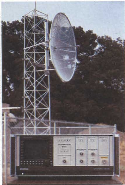
Fig. 3 - L'analizzatore di spettro HP 71200A per microonde permette analisi di spettro dei segnali da 50 kHz a 22 GHz oppure da 50 kHz a 26,5 GHz.
