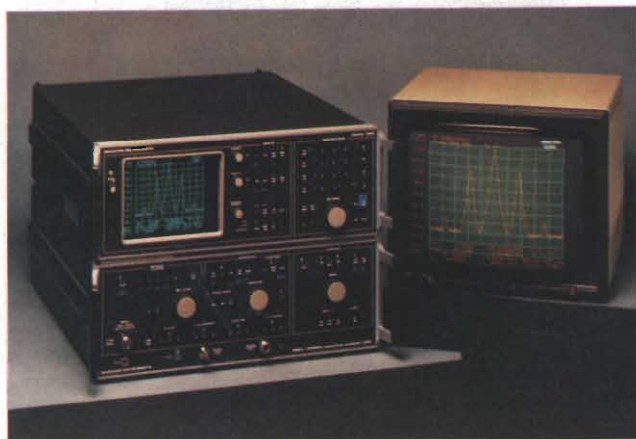
Fig. 1 - Analizzatore di spettro 2382 della Marconi Instruments. La banda coperta va da 100 Hz a 400 MHz, e pertanto può soddisfare a tutte le esigenze di analisi di segnali audio fino alla banda VHF. La presenza di un tracking generator permette di effettuare funzioni di modulazione in frequenza per il controllo della linearità di risposta di dispositivi e di reti. La dinamica dei segnali controllati va da -150 dBm a +30 dBm, ed è quindi ideale per controllare la presenza di prodotti di intermodulazione. Per una migliore osservazione delle forme d'onda è disponibile un monitor video a colori.
