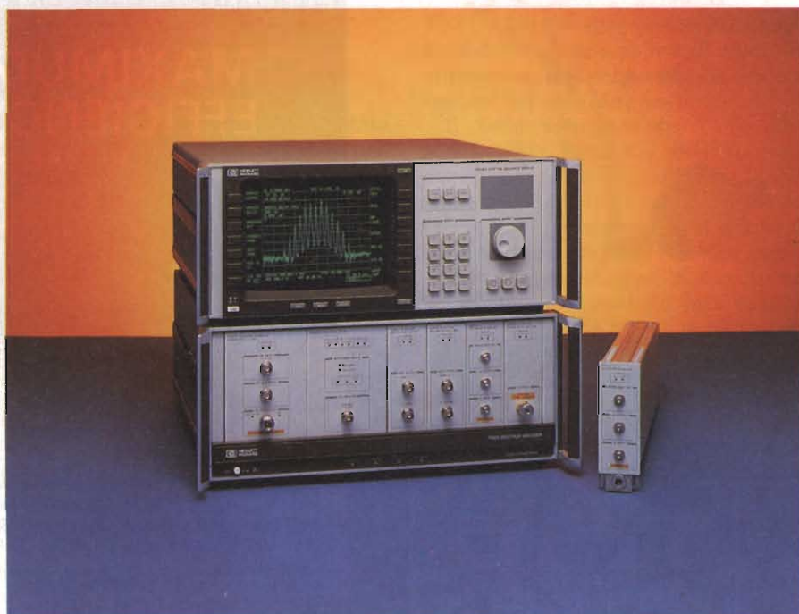
(In alto) Sistema di display Hewlett-Packard HP 70206A facente parte degli analizzatori di spettro modulari HP 71000. (In basso). I vari moduli del sistema sono inseriti nel mainframe. A destra, il modulo HP 70907A, interfaccia mixer esterna. Partendo da sinistra: modulo tracking generator, oscillatore locale, prima F.I., seconda F.I., e interfaccia mixer.
