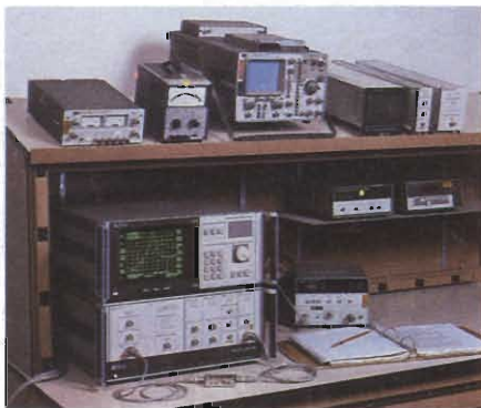
Fig. 4 - L'analizzatore di spettro HP 71000A è particolarmente adatto per analisi di spettro di segnali RF compresi tra 100 Hz e 2,9 GHz. Generalmente viene impiegato con il generatore tracking HP 70350A.
